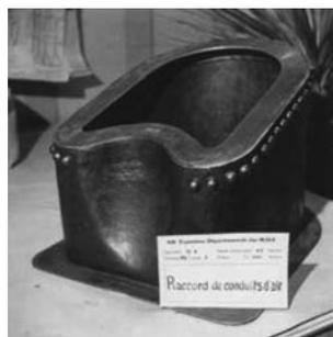
*Raccord de conduit d'air réalisé pour le concours MOF (photo MOF de H.J. Lachaume).*
