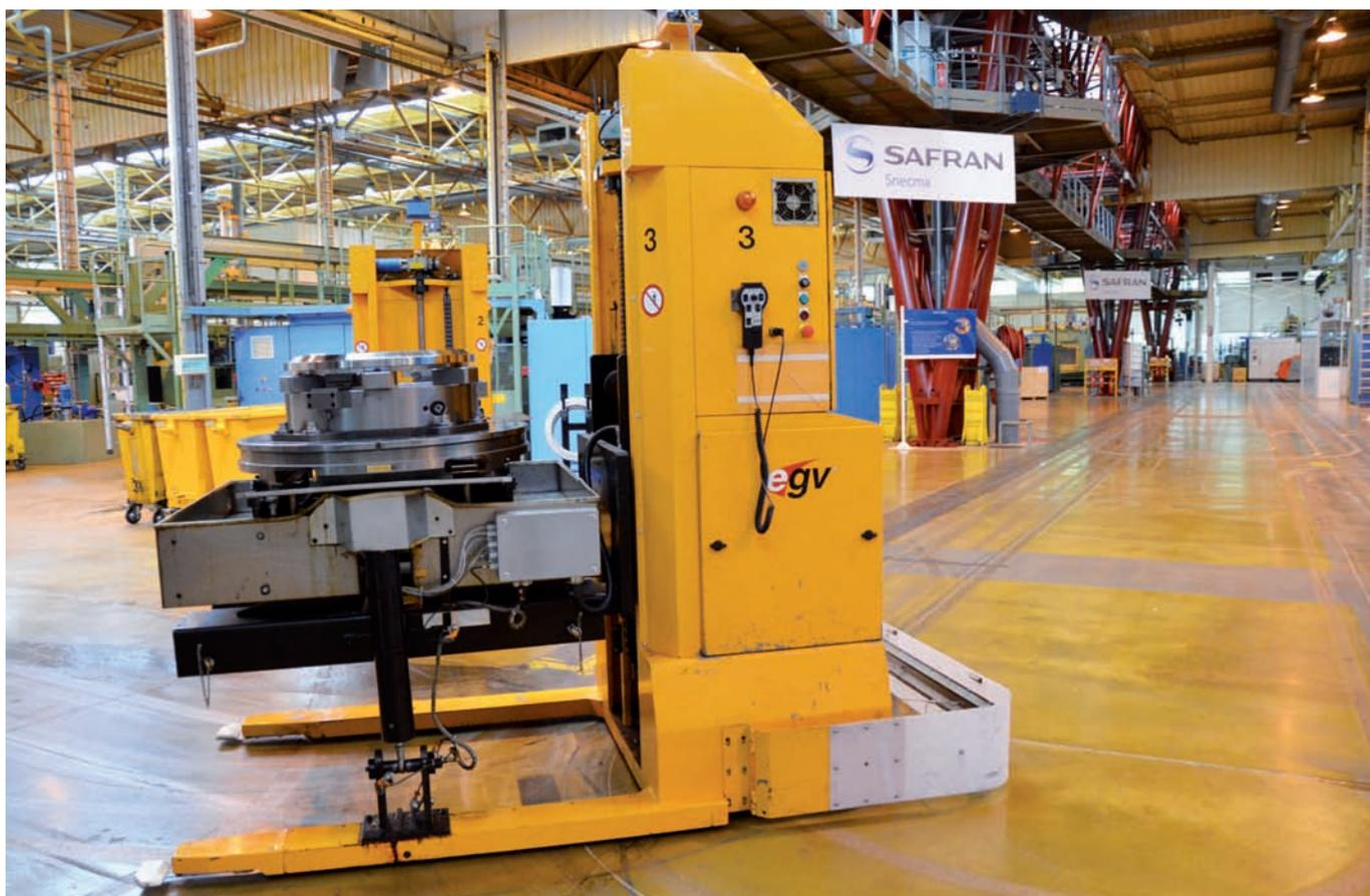
*chariot : chariot à guidage laser & pilotage wifi, alimentant la vingtaine de machines de l'atelier flexible, au cœur de la ligne de production
